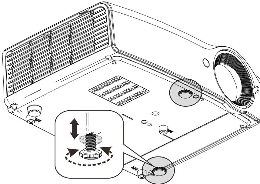
Zur Anpassung des Projektionswinkels drehen Sie den Neigungsregler im oder gegen den Uhrzeigersinn, bis der gewünschte Winkel erreicht ist.
